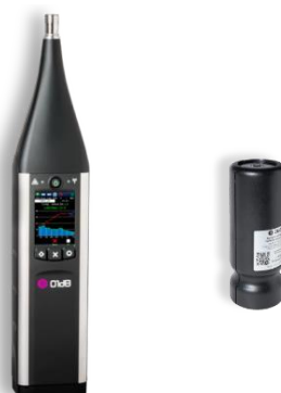
Figura 4 - Equipamentos utilizados durante o monitoramento de ruído.
